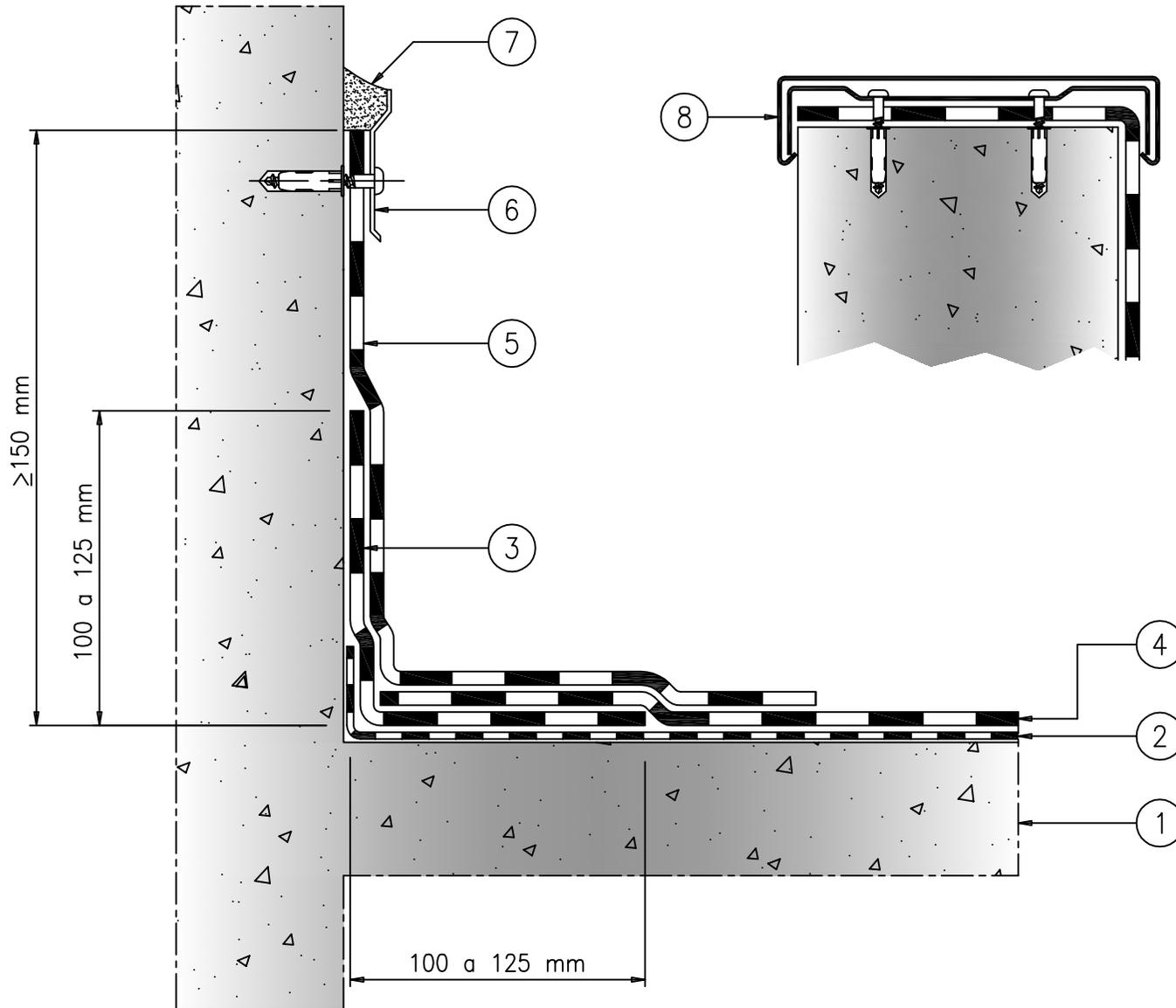
1. Supporto trattato con primer bituminoso "PRIMERTEC AD"
